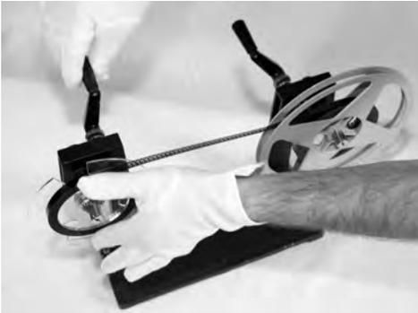
Ist das ganze Filmmaterial umgespult, so löst man die Umspulhilfe vom Umspularm und schiebt den Filmkuchen seitlich ab dem Plexiglas Kern. Das muss mit Vorsicht geschehen, denn der Film ist ja locker aufgespult. Wenn hier ein Fehler passiert, hat man einen grossen Salat.
