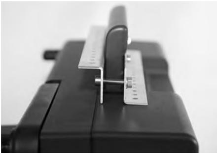
Bei der Handgriff-Halterung wird der Griff zwischen zwei Alu-Profilen eingeklemmt. Die Profile werden von zwei oder drei Schrauben zusammengehalten. Ein Profil liegt mit der Lochung nach unten, eines mit der Lochung nach oben. Das mit der Lochung nach oben muss auf der Bedienungsseite des Projektors liegen, da auf diesem Profil Looper 8 montiert wird.
