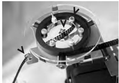
Liegt das Filmmaterial schön auf, so kann die Abdeckung mit den zwei Flügelmuttern montiert werden. Nicht zu fest anziehen! Dann kann der Film normal in den Projektor eingefädelt werden. Es ist darauf zu achten, dass er schön über die Rollen des Loofer 8 zu liegen kommt.
