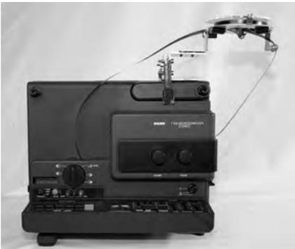
Die Schraubzwingen-Halterung wird an einer Schraubzwinde montiert (s. Abbildung), welche quer am Projektor angebracht ist. Bitte beachten, dass viele Projektorengehäuse aus Kunststoff sind und nicht mit beliebiger Kraft zusammengedrückt werden können. Das unten liegende Profil wird auf die Projektoroberseite aufgelegt und ermöglicht es so, dass die Halterungsplatte für den Looper wirklich horizontal steht.
