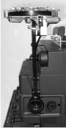
Mittels der Langlöcher im Looper-Fuss kann dieser horizontal so verschoben werden, dass der Film schön vertikal runter in den Projektor läuft.
