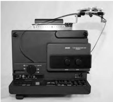
Der Looper 8 wird mittels zwei M3 Schrauben auf dem Profil befestigt, das mit der Lochung nach oben steht. Es muss die vertikale und die horizontale Position beachtet werden.
